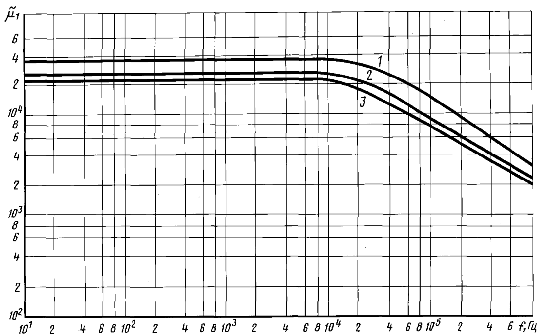
Зависимость \tilde{\mu} от частоты для сплавов в лентах толщиной 0,02 мм марок: 1 — 83НФ; 2 — 80НХС; 3 — 79НМ
